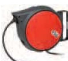
Cubierta de material plástico antichoque. Abrazadera de sujeción de metal, orientable. Dispositivo automático de parada del tubo. Tubo de poliuretano brillante. Temperatura ambiente de uso -5°C/+40°C. Adecuado para el paso de aire y agua fría.
