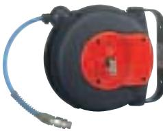
Cubierta de material plástico antichoque. Abrazadera de sujeción de metal, orientable. Dispositivo de parada de cremallera que se puede introducir cada 50 cm. Tubo de poliuretano extruido. Temperatura ambiente de uso -5°C/+40°C. Adecuado para el paso de aire y agua fría.
